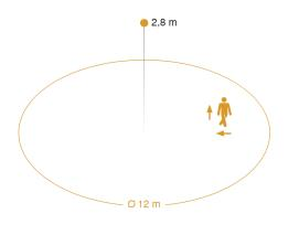
Mögliche Montagehöhe: 2,50 m – 4,00 m Orange: radial und tangential Dimension Drawing
